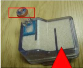
Wenn diese Ringdichtung beschädigt wird, wird die Dampfzufuhr beeinträchtigt. In diesem Fall muss der Filter ausgetauscht werden.
